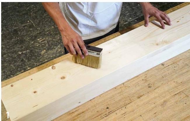
Antes del encolado, hay que limpiar esmeradamente la superficie, asegurándose de que quede lisa, uniforme y sin irregularidades. Evaluar cualquier daño en la superficie y, si es necesario, tratarlo debidamente antes de colocar la lámina.
